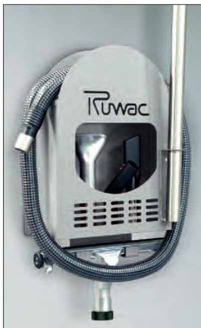
Schlauch- und Zubehörhalter, Stahlblech, RAL 7035 (grau), Montage an der Wand, L - 540 mm, B - 252 mm, H - 735 mm für Zubehör 50 mm Ø, Schlauch, ca. 10,0 m
