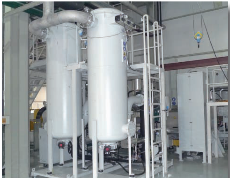
Polyestervorabscheidung mit automatischer Umschaltung für eine kontinuierliche Produktion Polyester pre separation with automatic change over for continuous operation
