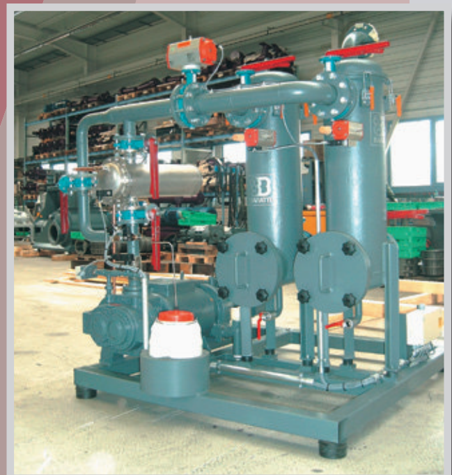
trockenlaufender Vakuumpumpstand PP Entgasung / dryrunning vacuumsystem degassing PP
