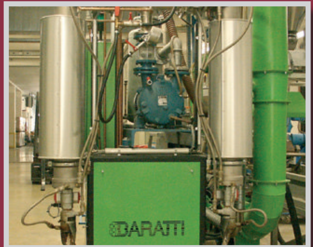
Vakuumentgasung Polyamid / extruder degasing polyamid
