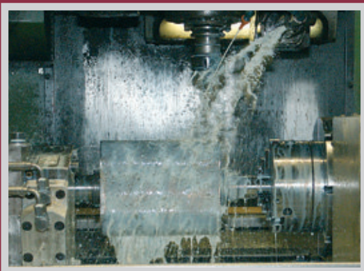
CNC-Bearbeitung Drehkolben / CNC lobe machining
