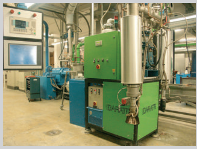
Vakuumentgasung Polyamid / vacuum degassing of polyamid extruder
