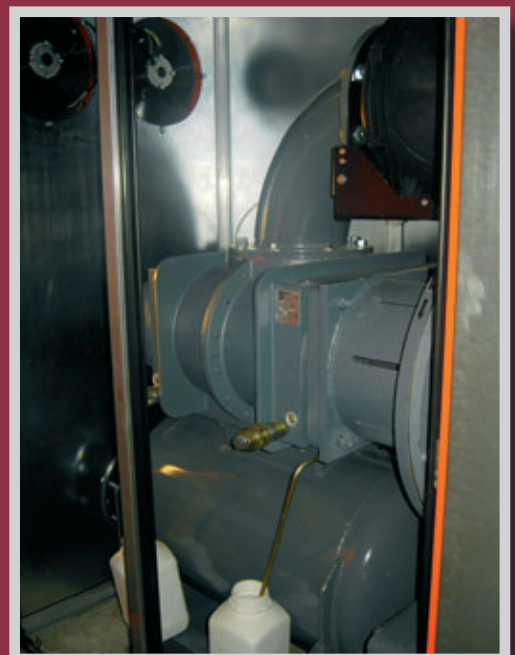
Vakuumentgasung Polyamid / extruder degasing polyamid
