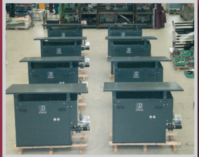
ATMOS Druckgebläse, 1,8 bar für Gaseinpressung, Außenaufstellung / ATMOS D 1 KR - sludge injection 1.8 barg, outdoor installation
